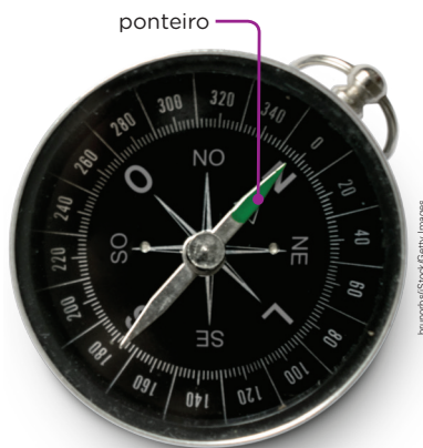
▲ O ponteiro (agulha) da bússola funciona como um ímã. A ponta destacada em verde sempre aponta para o Norte geográfico.
