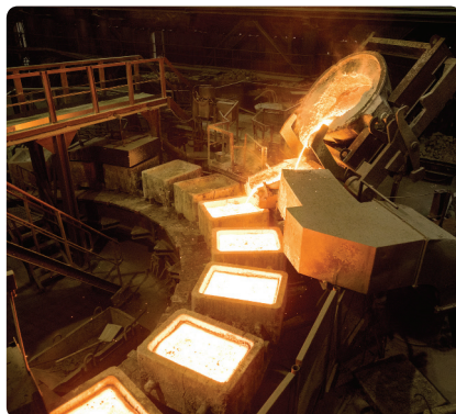
▲ Metal no estado líquido em alta temperatura é colocado no molde. Ao esfriar, ele volta ao estado sólido no mesmo formato do molde.
