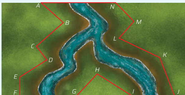
Figura 2: A planimetria relaciona as medidas lineares e de ângulos em um plano horizontal, em que se faz uma análise plana do terreno. Note que é possível perceber o traçado do rio, mas não são fornecidas informações sobre as altitudes.
