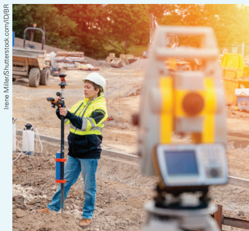
Topógrafa utilizando equipamento para medir ângulos e distâncias simultaneamente em levantamentos topográficos.
