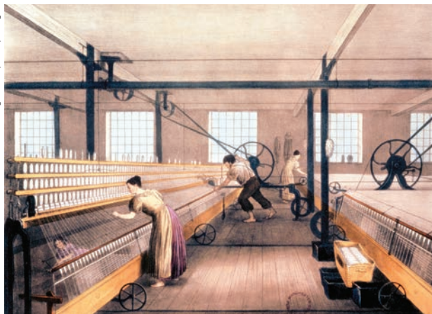
Fiação de algodão com máquinas automáticas movidas por força hidráulica ou a vapor. Gravura de cerca de 1835.
