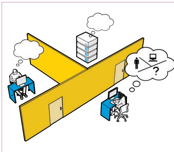
Ilustração do teste de Turing, em que um avaliador conversa com um computador e com um humano e precisa identificar quem é o indivíduo e quem é a máquina.
