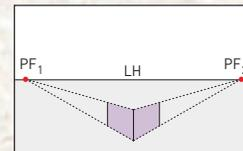
**2** Traçamos linhas retas ligando as pontas da aresta aos pontos de fuga ( $PF_1$  e  $PF_2$ ). Depois, traçamos segmentos paralelos à aresta, obtendo, assim, dois lados do bloco retangular.
