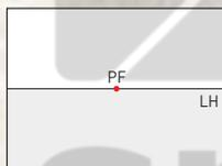
**1** Representamos a **linha do horizonte** (LH), uma linha no plano dos olhos do observador, e, sobre ela, indicamos o **ponto de fuga** (PF).
