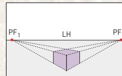
**3** Traçamos linhas retas entre os extremos dos novos segmentos e os pontos de fuga ( $PF_1$  e  $PF_2$ ), de modo que formem o restante do bloco retangular.
