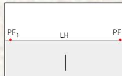
**1** Representamos a linha do horizonte (LH) e, sobre ela, os dois pontos de fuga ( $PF_1$  e  $PF_2$ ). Em seguida, desenhamos a aresta frontal do bloco retangular.
