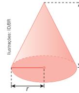
$$V_{\text{cone}} = \frac{1}{3} A_{\text{base}} \cdot H$$
