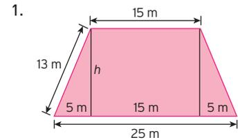
Como a parede tem o formato de um trapézio isósceles, pode-se decompor o trapézio em dois triângulos retângulos e um retângulo.
