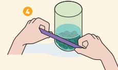
4 Colem uma fita adesiva na base da garrafa para marcar o limite da água. Durante as medições, a água da chuva ficará acumulada acima dessa marca.
