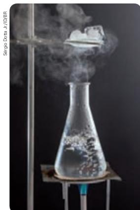
↑ Com o aquecimento, a água contida no recipiente sofre ebulição. O vapor de água atinge a superfície inferior do vidro onde há gelo e provoca sua fusão. Gotículas de água, resultantes da condensação do vapor, são formadas sobre a superfície interna do vidro que contém água em ebulição.
