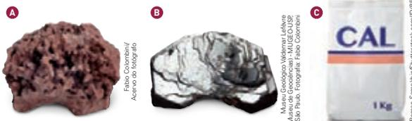
Um dos principais componentes da bauxita (A) é o óxido de alumínio ( $\text{Al}_2\text{O}_3$ ); esse óxido é extraído da bauxita e transformado no metal alumínio. A hematita (B), principal fonte de ferro, tem em sua composição o óxido de ferro (III) ( $\text{Fe}_2\text{O}_3$ ), que é retirado dela e transformado em metal. A cal virgem (C), utilizada em construções e na produção de argamassa, também é constituída de um óxido – o óxido de cálcio ( $\text{CaO}$ ).
