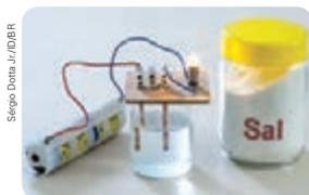
↑ Na montagem, observa-se o composto iônico sal de cozinha que, dissolvido em água, conduz eletricidade. Isso é evidenciado pela lâmpada acesa.
