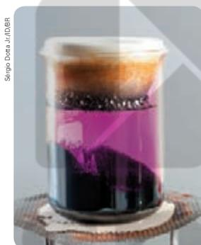
↑ Quando aquecido, o iodo (um sólido de cor escura) sofre sublimação, formando um gás de cor púrpura. Esse gás sublima, voltando ao estado sólido, quando entra em contato com a superfície externa da cápsula de porcelana, colocada sobre o biquê.
