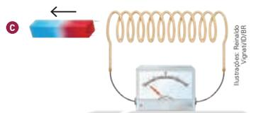
↑ Esquema do aparato experimental construído por Faraday para demonstrar a indução eletromagnética. Em (A) e em (C) o movimento do ímã provoca o aparecimento da corrente elétrica. O ímã parado (B) não induz o aparecimento da corrente elétrica.
