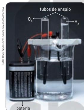
↑ Antes da eletrólise, os tubos de ensaio estão completamente cheios de água. Quando a bateria é conectada aos fios, ocorre a passagem de corrente elétrica pelo sistema e a energia fornecida pela bateria promove a decomposição da água nos gases oxigênio (à esquerda) e hidrogênio (à direita).
