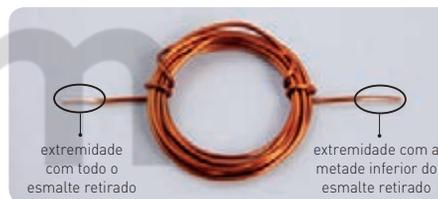
← Modelo da bobina com as extremidades raspadas de acordo com o previsto no projeto.
