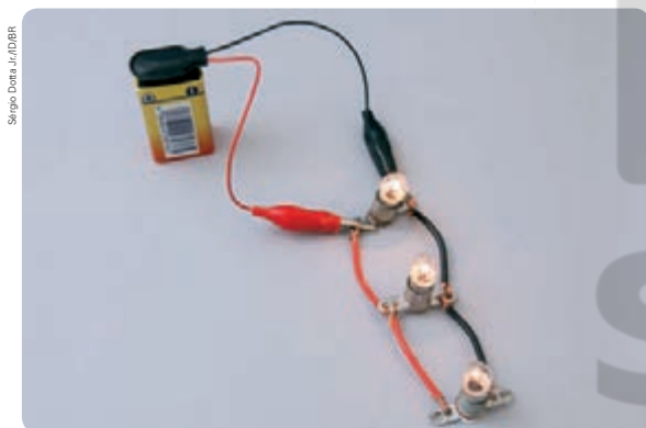
↑ O movimento ordenado de elétrons, por meio de fios condutores, acende as lâmpadas.
