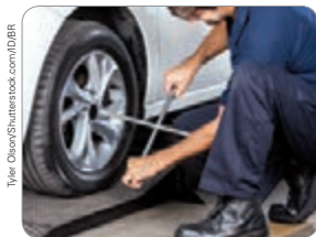
↑ A chave de roda é um exemplo de alavanca. A força aplicada na barra transversal é transmitida para o eixo da chave.
