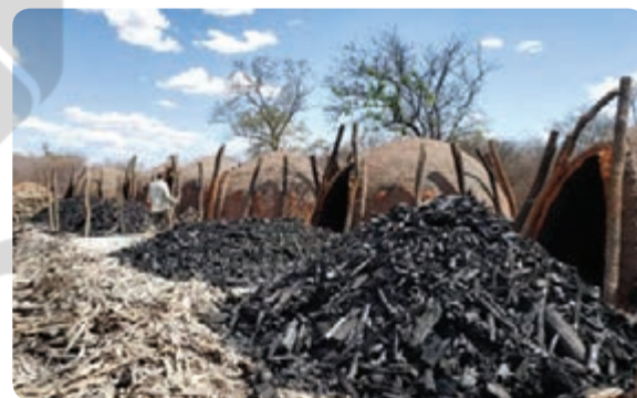
↑ Fornos como os da foto são usados para produzir carvão vegetal em municípios em que predomina o bioma Caatinga. Em alguns casos, é usada madeira proveniente de desmatamentos ilegais. Guanambi (BA). Foto de 2019.
