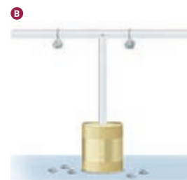
↑ Esquema da montagem com duas porcas do lado esquerdo e quatro porcas do lado direito. (Representação sem proporção de tamanho; cores-fantasia.)
