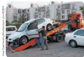
↑ O plano inclinado permite que esse carro seja rebocado para cima do caminhão-guincho.
