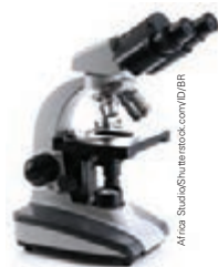
↑ Nos microscópios de luz, o objeto a ser ampliado é iluminado por uma lâmpada. Ele consegue gerar imagens ampliadas em até cerca de 2 mil vezes.
